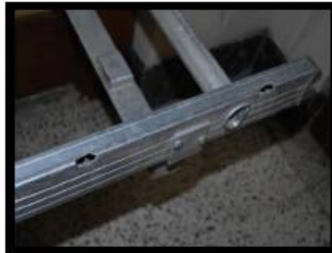
Perforación en larguero Cambiar escalera
