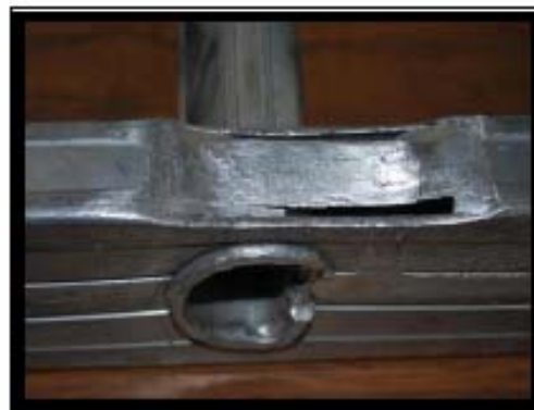
Larguero en malas condiciones por desgaste excesivo Cambiar escalera
